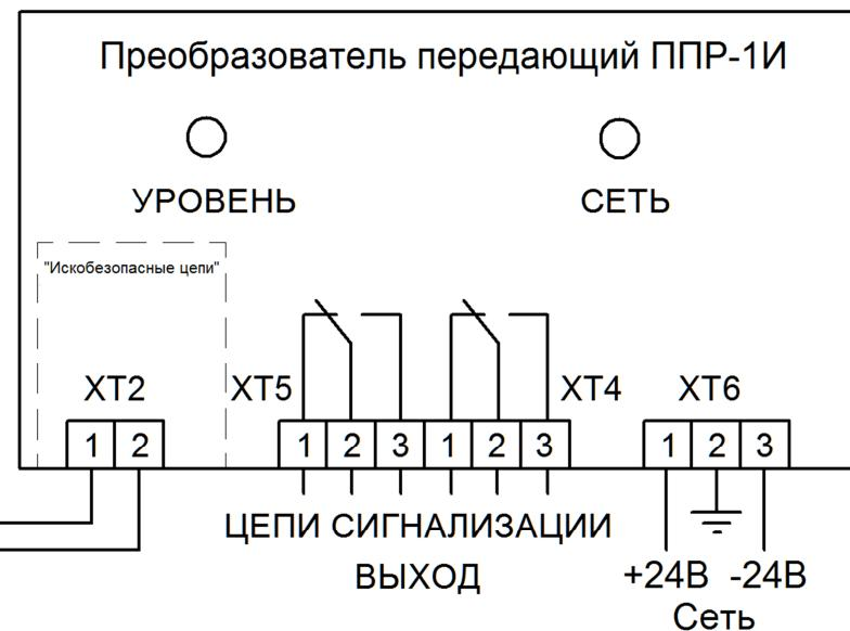
Рисунок И.4 – Схема электрическая подключения датчика-реле РОС-101И (24В) (взрывозащищенное исполнение)
