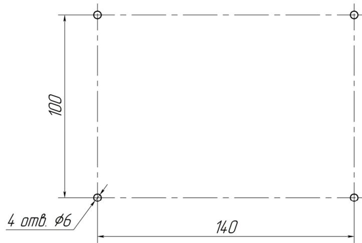
Рисунок А.2 – Габаритные и установочные размеры ППР-1
