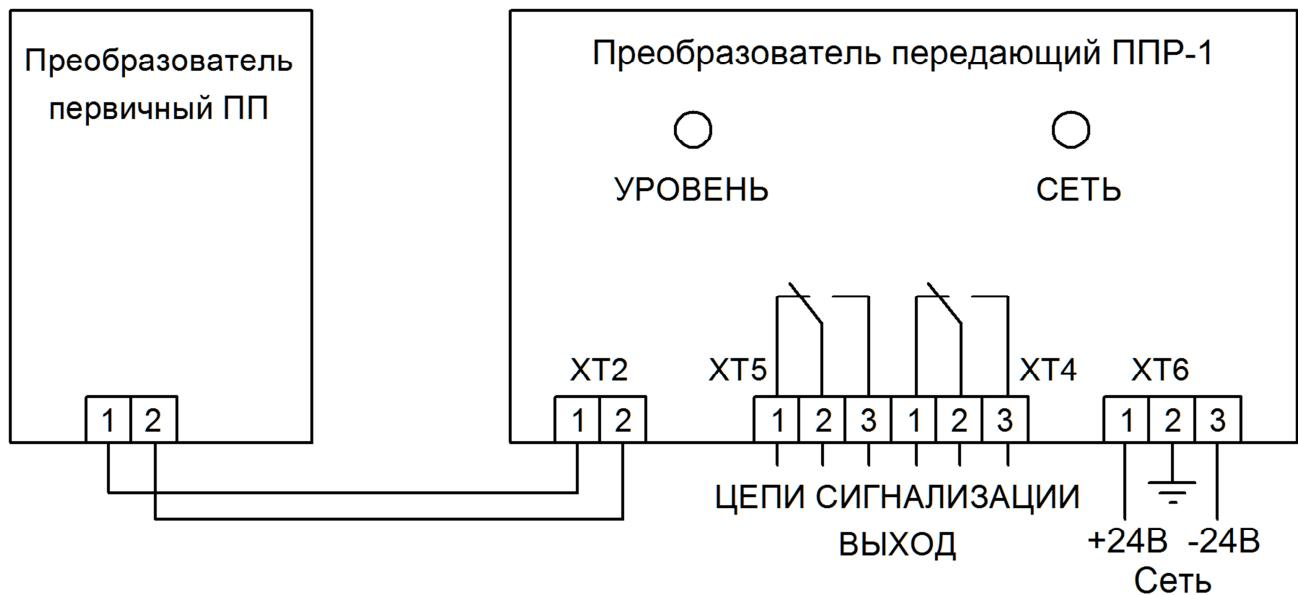
Рисунок И.2 – Схема электрическая подключения датчика-реле РОС-101 (24В)
