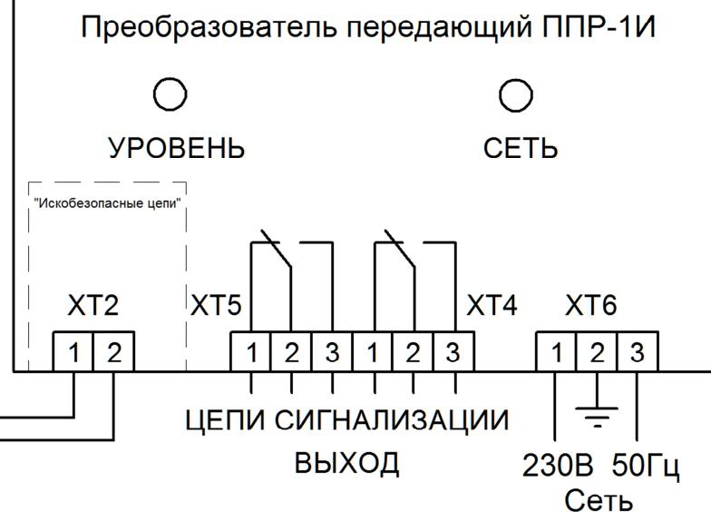
Рисунок И.3 – Схема электрическая подключения датчика-реле РОС-101И (230В) (взрывозащищенное исполнение)
