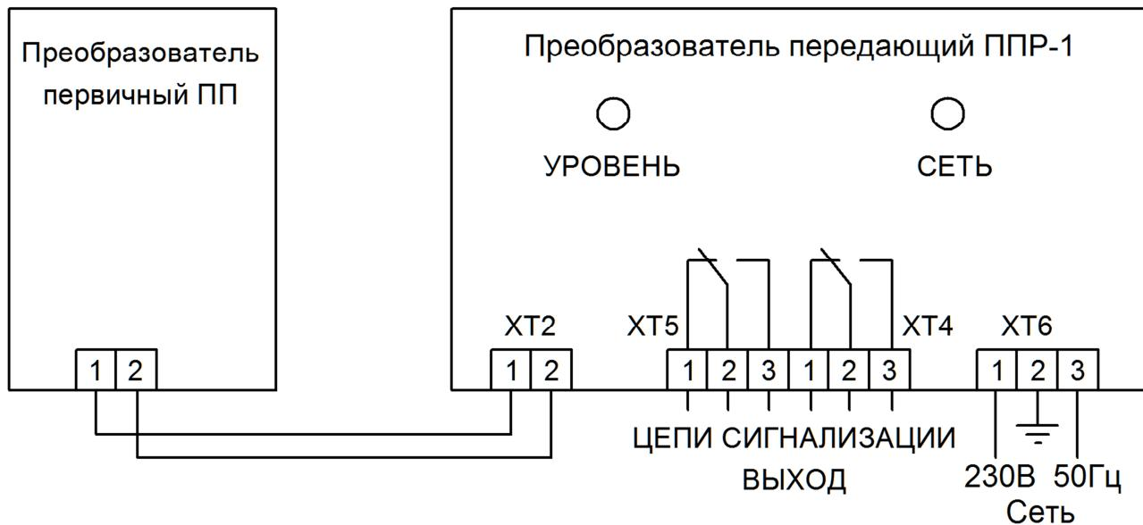
Рисунок И.1 – Схема электрическая подключения датчика-реле РОС-101 (230В)
