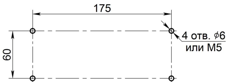
Рисунок А.1 – Габаритные и установочные размеры ППР-1
