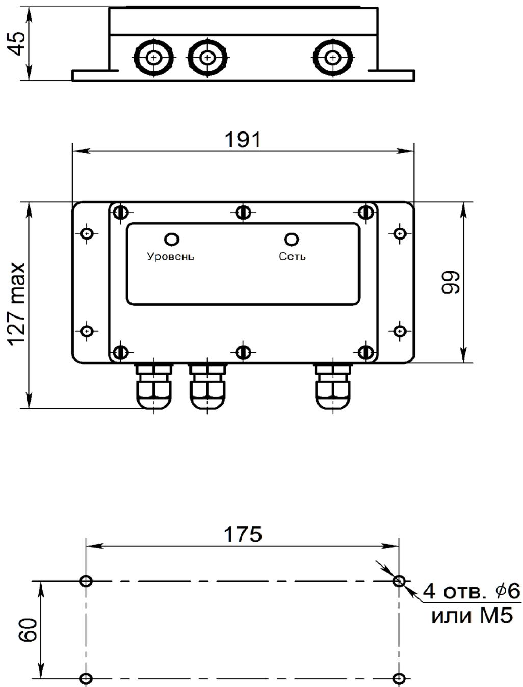
Рис. А.1 – Габаритные и установочные размеры ППР
