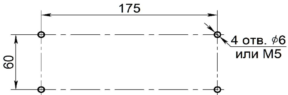
Рис. А.1 – Габаритные и установочные размеры ППР
