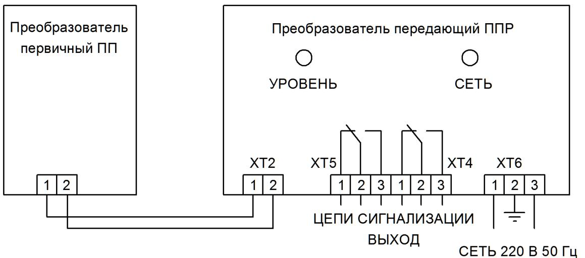
Рис. Е.1 – Схема электрическая подключения датчика-реле РОС 101
