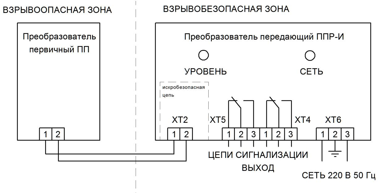
Рис. Е.2 – Схема электрическая подключения датчика-реле РОС 101И
