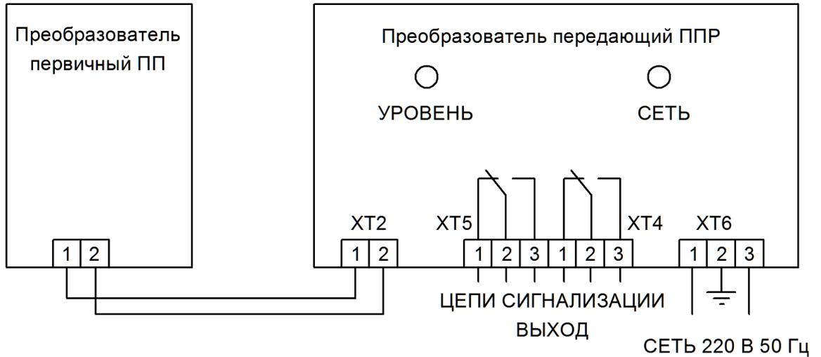
Рис. Е.1 – Схема электрическая подключения датчика-реле РОС 101
